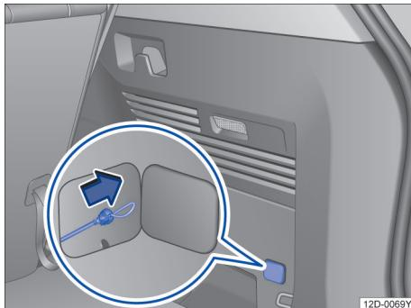
图 148 行李厢内的交流充电插头应急解锁拉索
