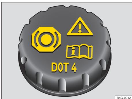
图 166 前舱内：制动液容器的盖子
