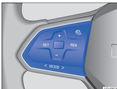
图 112 多功能方向盘左侧：定速巡航系统操作按钮
