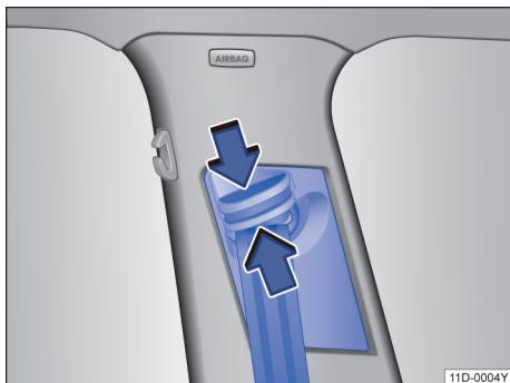
图 26 前座椅：安全带高度调整机构
