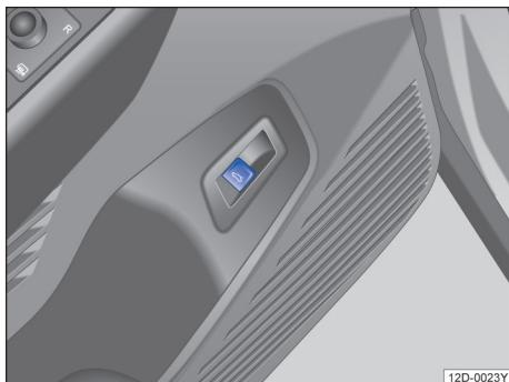
图 51 在驾驶员侧车门内：电动打开行李厢盖的按钮
