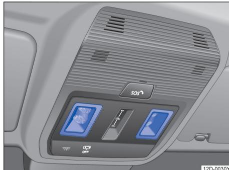
图 91 顶篷中控台中：触摸感应式阅读灯
