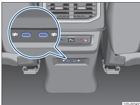
图 134 后排位于出风口下方 Type-C 插口
