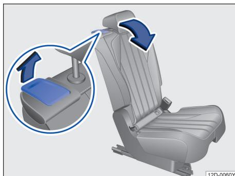
图 67 第二排座椅：上车辅助功能的操作杆
