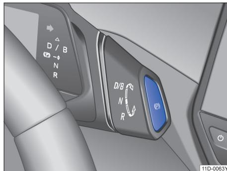
图 124 电子驻车制动器按钮
